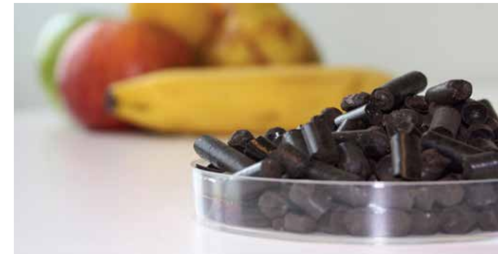
Können in der Industrie und in Privathaushalten zur sauberen Verbrennung genutzt werden: Pellets aus Biokohle, hergestellt durch hydrothermale Karbonisierung.
