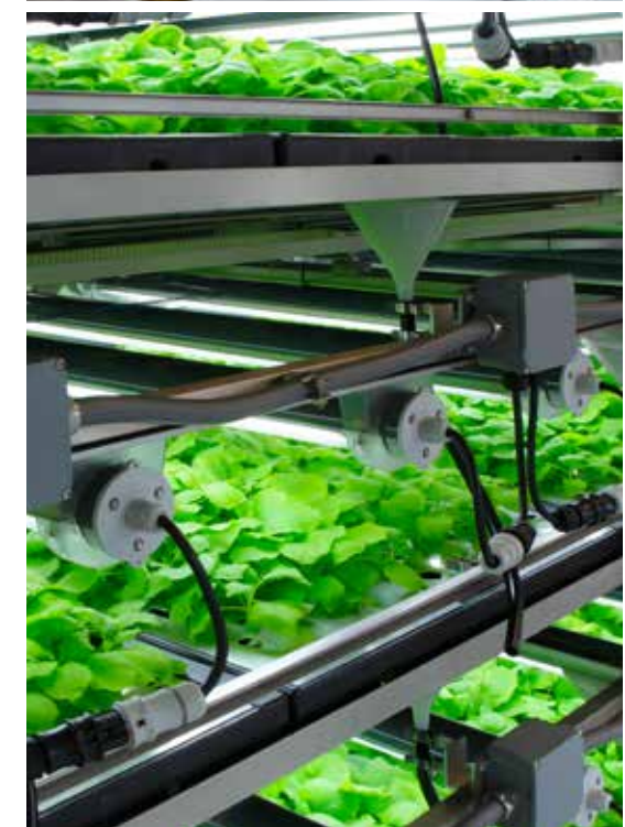
Mit einem automatisierten System werden die Wachstumsschalen mit den Pflanzensamen in Wachstumsschalen aus Edelstahl befestigt, in einem klimatisch streng kontrollierten Raum. Hier wachsen die Pflanzen 4 bis 5 Wochen lang, bis sie reif genug sind für den Vakuum-Infiltrationsprozess.
